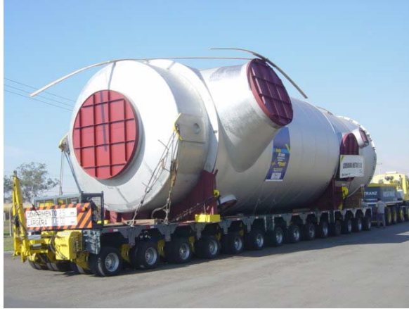
Trocador gás / gás P1101 fornecido a Caraíba Metais
