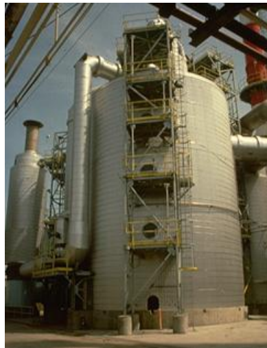
Conversor para planta de 1100 ton/dia de ácido regenerado nos EUA - 1988
