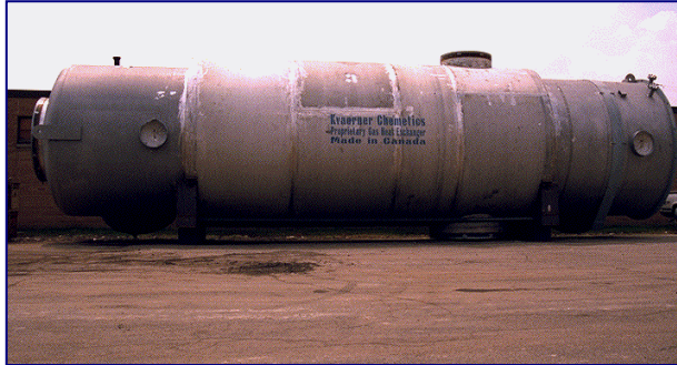
Trocador de re-aquecimento intermediário para a Thai Copper Pronto para embarque na planta da AKC em Toronto.
