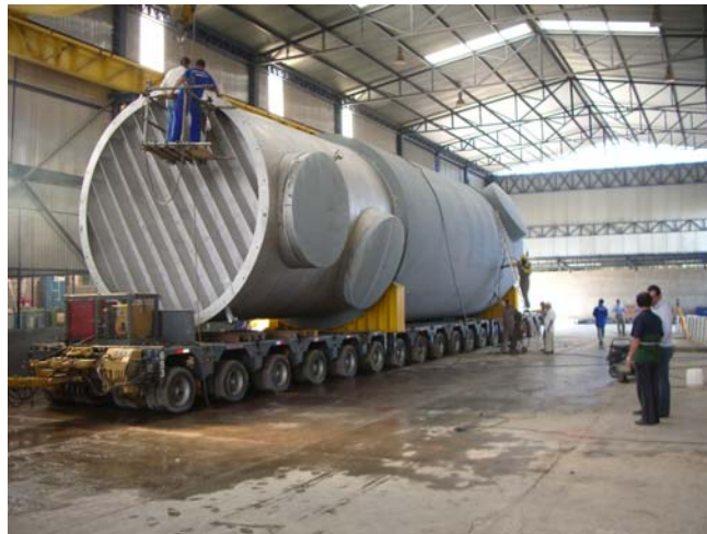
Trocador gás / gás P1104 fornecido a Caraíba Metais
