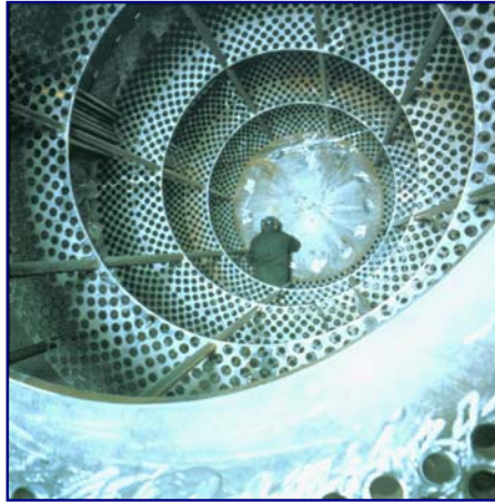
Trocador gás / gás em processo de fabricação na divisão Chemetics da Aker Kvaerner em Toronto.
